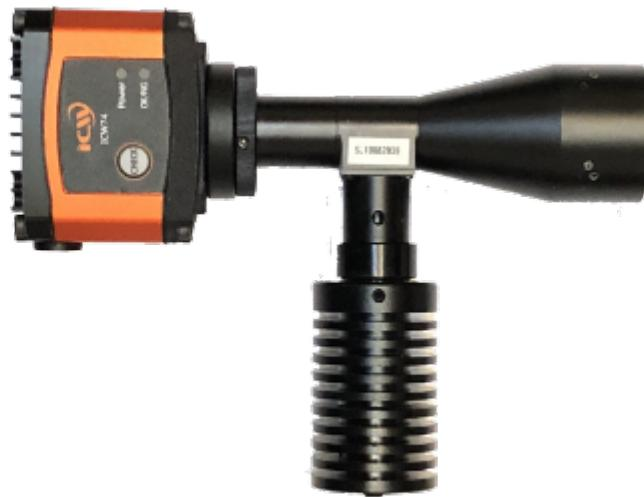
按住触发键不放，照明灯被启动，出现红色照明区域及红色对焦线。将红色对焦线对准条码中心，移动vericode读码器并调整它与条码之间的距离，来找到较佳识读距离。听到成功提示音响起，同时红色照明线熄灭，则读码成功。vericode读码器将解码后的数据传输至主机。vericode读码器安装方法：插入数据线：将数据线的水晶头接入vericode读码器的底部接口，注意：如果插入之后可以直接拔出，说明没有插好，因为插好后是不能直接拔出的。连接电脑：vericode读码器一般有3个接口可选，常用USB接口。连接电脑的时候将vericode读码器数据线插口插入电脑相应的接口上，稍等电脑自动安装驱动之后，即可使用。取线方法：用一个小别针插入取线孔，稍微用力挤压然后就可以拔出数据线。正确使用vericode手持读码器要确保读码器、数据线、数据接收主机和电源等已连接后开机。浙江液晶显示屏vericode手持读码器
