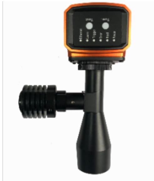
vericode工业读码器在自动化中的应用如下 vericode工业读码器主要用于工业自动化领域，以进行过程追踪和过程质量监控，例如制造，测试，包装和仓储产品出入库。制造过程追踪：使用条码识别每个项目，在整个供应链过程中的共享数据，实现项目流程的记录，在整个过程的关键链接中读取项目的条码，并记录进出的记录项目信息；质量监督：为加强质量控制，工业企业在产品上标记条码符号，在产品的整个生命周期中实时记录产品信息，如生产状态和质量检验状态，并实现可追溯性，标记符号质量等功能验证，制造检查过程追踪识别等，以帮助用户做出生产判断和决定。
